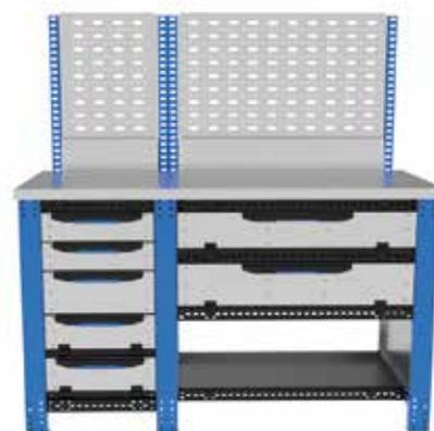
Небольшой верстак длиной 1400мм, шириной 600 мм и высотой 825 мм оснащен ящиками и полками с откидными дверцами. Верстак может использоваться для слесарных работ в мастерской и как рабочий стол комплектовочного участка.
